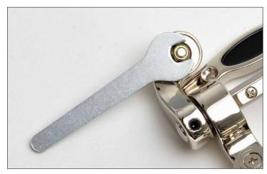
In der ersten Zeit wird sich diese Mutter noch etwas lockern. Sie kann aber auch später noch jederzeit nachgestellt werden. Dazu hebt man den Hebel einfach an, so dass man die Feder herausnehmen kann. Dann kann man die Mutter mit dem beiliegenden **8mm Schraubenschlüssel** nachjustieren.
