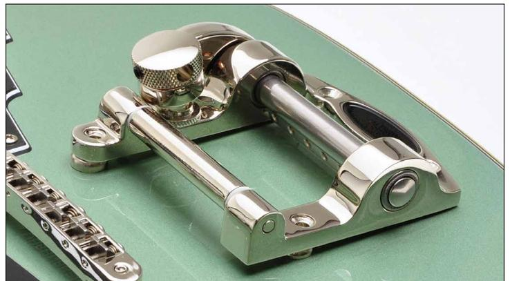
Um den Winkel zu verkleinern, wird das Tremolo „aufgebockt“. Hierzu werden Unterlegscheiben (z.B. das **göldo Washer Set TGDWSN/TGDWSG**) an den beiden vorderen Montageschrauben unter den Rahmen des Tremolos gelegt. An der hinteren Kante liegt das Tremolo auf der Decke auf, was für einen passenden Andruckwinkel sorgt.
