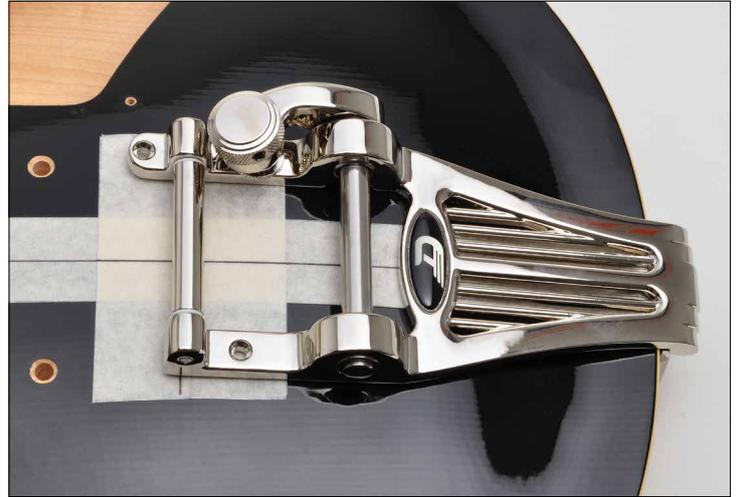
Dann erfolgt die Positionierung der beiden vorderen Befestigungsschrauben. Die seitliche Position wird durch Anlegen eines dünnen Fadens in die Sattel- und Stegkerben beider E-Saiten überprüft. Das Tremolo wird dann seitlich so ausgerichtet, dass der Faden an der Niederdruckrolle den gleichen Abstand zu beiden Enden der Rolle hat. Dann werden die Positionen der Bohrungen auf der Decke markiert.
