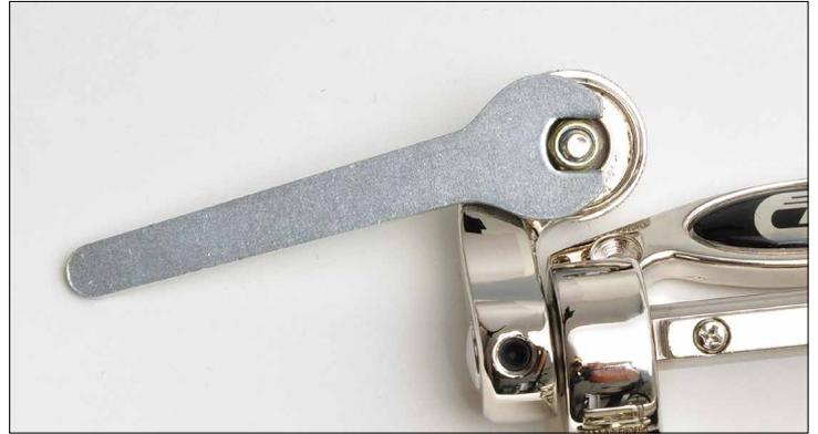
In der ersten Zeit wird sich diese Mutter noch etwas lockern. Sie kann aber auch später noch jederzeit nachgestellt werden. Dazu hebt man den Hebel einfach an, so dass man die Feder herausnehmen kann. Dann kann man die Mutter mit dem beiliegenden **8mm Schraubenschlüssel** nachjustieren.
